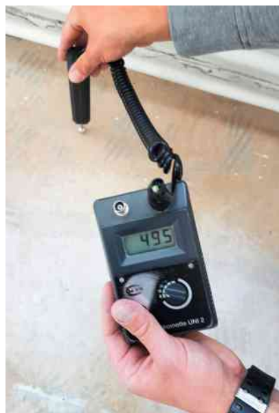
Mithilfe von Widerstandsmessgeräten wurde der Trocknungsfortschritt im Intervall einer Woche gemessen.
